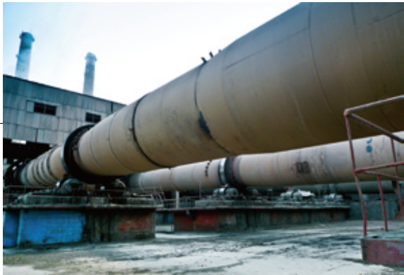
图为永登祁连山水泥公司即将停产的湿法线。2010年8月2日，通达中国水泥万里行团队访问永登祁连山时了解到，永登祁连山（原名永登水泥厂）的湿法线将于9月全面停产。此前，永登祁连山共拥有六条湿法水泥熟料生产线，其中四条已经停产，还在运行、专门用于生产特种水泥的两条湿法线也将于一个月后结束自己的历史使命。就在边上，新型干法水泥生产线正在紧锣密鼓地建设中。
