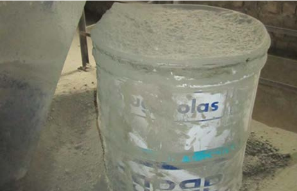
新油桶放在现场，被大量的粉尘覆盖
