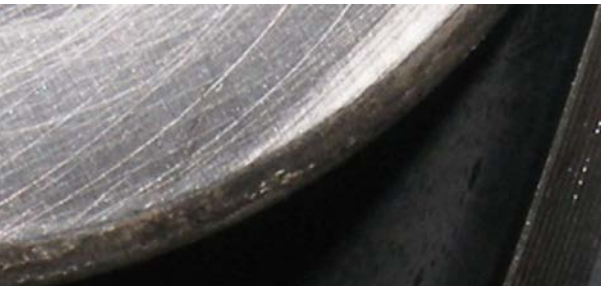
滚道杂质压伤及磨损
