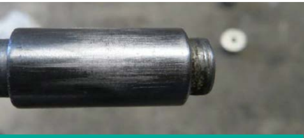
分配器柱塞磨损
