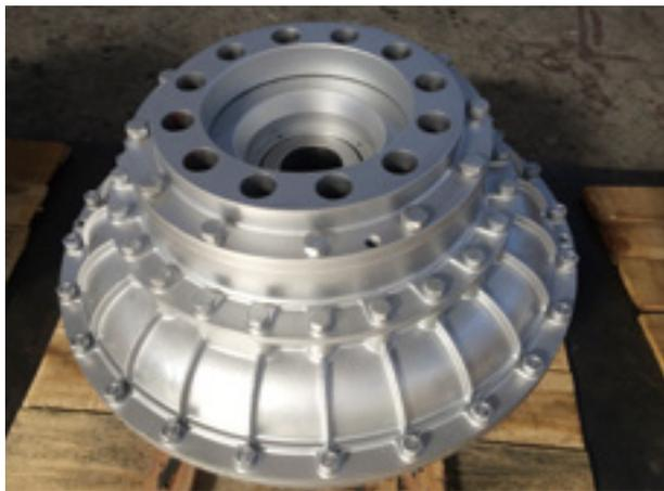
液力耦合器具有轻载启动、过载保护、减缓冲击、隔离振动、协调多动力机械同步驱动、均衡荷载、柔性制动等性能，广泛用于冶金、水泥、化工等行业，在大功率驱动的机械上优点尤为突出。随着水泥行业的不断发展，水泥机械上选用液力耦合器极为普遍，例如提升机、输送机、破碎机、球磨机等。选好、用好、维护好液力耦合器关系到能源利用、设备使用寿命及财产安全等，本文主要介绍在水泥机械上怎样使用液力耦合器。
