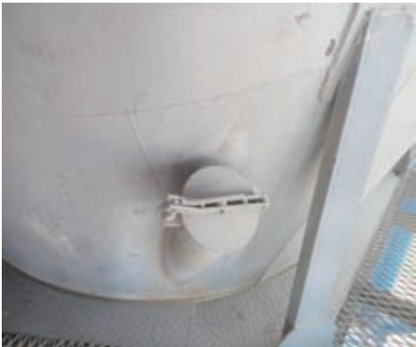
预热器捅灰孔（内部含凹槽，盘根密封）
