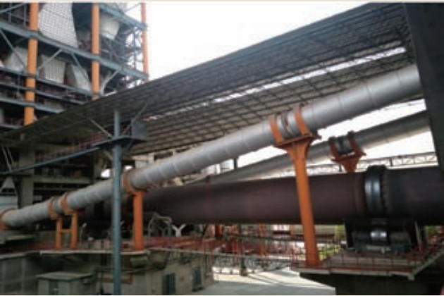
图1.KHDΦ5.2×61m两档短窑
