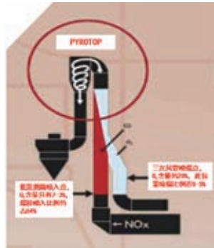
图5.低氮煤粉喷入位置示意图
