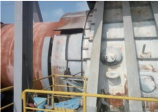
窑头密封（鱼鳞片式柔性密封，外部制作回灰收集罩）
