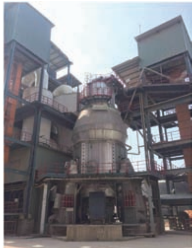
图3.七号砂岩磨,用于研磨砂岩粉
