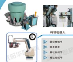
袋装水泥：根据现场情况对水泥袋装包装机进行改造，增加自动插袋机等自动化设备，减少人员岗位配置，提供包装效率。引入自动堆包机器人，根据车辆的大小进行分别建模，实现袋装水泥装车的自动化。从而减少粉尘，实现装车无人化。
