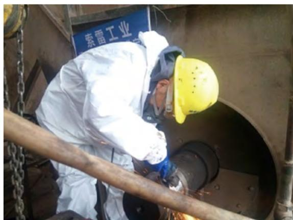
索雷工程师打磨处理风机轴表面
