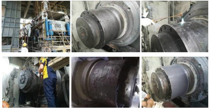
《合肥院160-140辊压机轴承位磨损修复》
