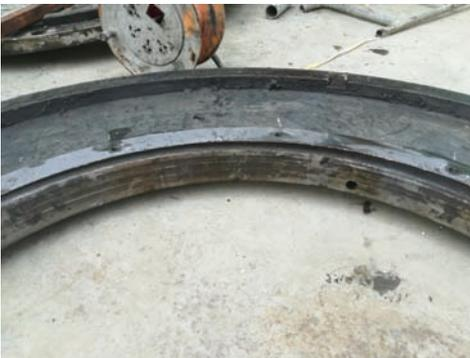
(3) 润滑失效:辊压机轴承的润滑一般采取油脂润滑,如果不能及时加注润滑油或者润滑系统油路堵塞,将直接导致轴承润滑失效,轴承温度持续上升,最终出现烧蚀的情况发生;
