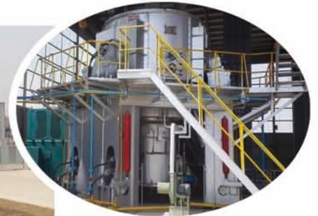
江苏省首批认定的年产120万吨水泥节能粉磨示范生产线——沭阳沂淮集团使用我公司生产的VPM2400预粉碎立磨、 $\phi 4.2 \times 13\text{m}$ 开流球磨机组成的联合半终粉磨系统。生产P.042.5时：台时产量260T/H，系统单位电耗24.5Kwh/吨水泥；生产P.C32.5时：台时产量280T/H，系统单位电耗22.8Kwh/吨水泥，节电30%以上。
