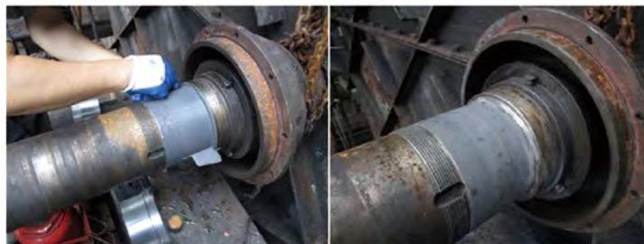
拆卸工装并进行后续处理回复原有尺寸
