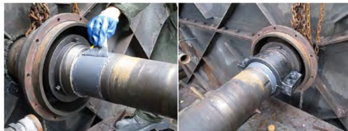
涂覆索雷碳纳米聚合物材料并夹固工装
