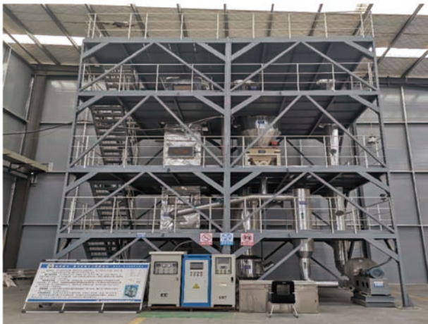
图4 大型窑尾烟气试验平台（模拟C1出口烟气条件）
