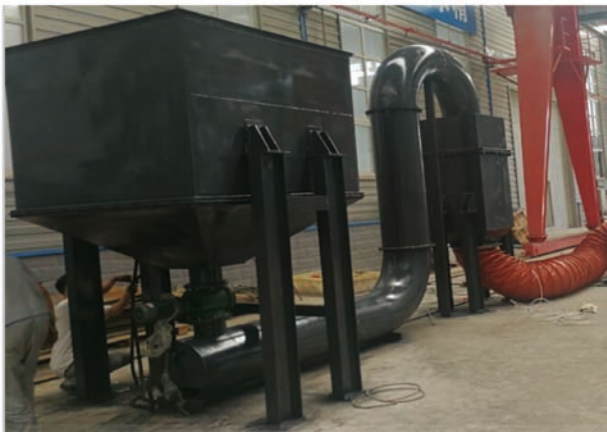
图5 水泥行业专用催化剂清灰、防堵塞、磨损试验装置
